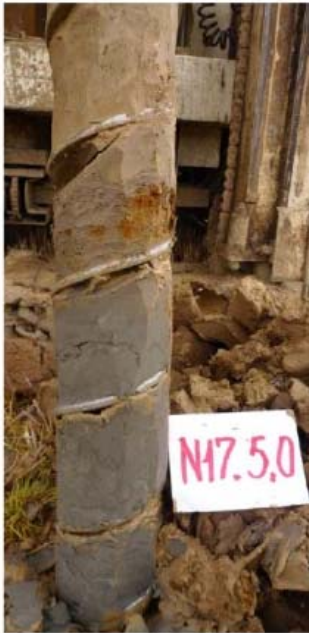
Farveskift i typisk moræne ler fra brunt til gråt. Farveskift lokaliserer redoxgrænsen. V. Ernstsén (2013)
