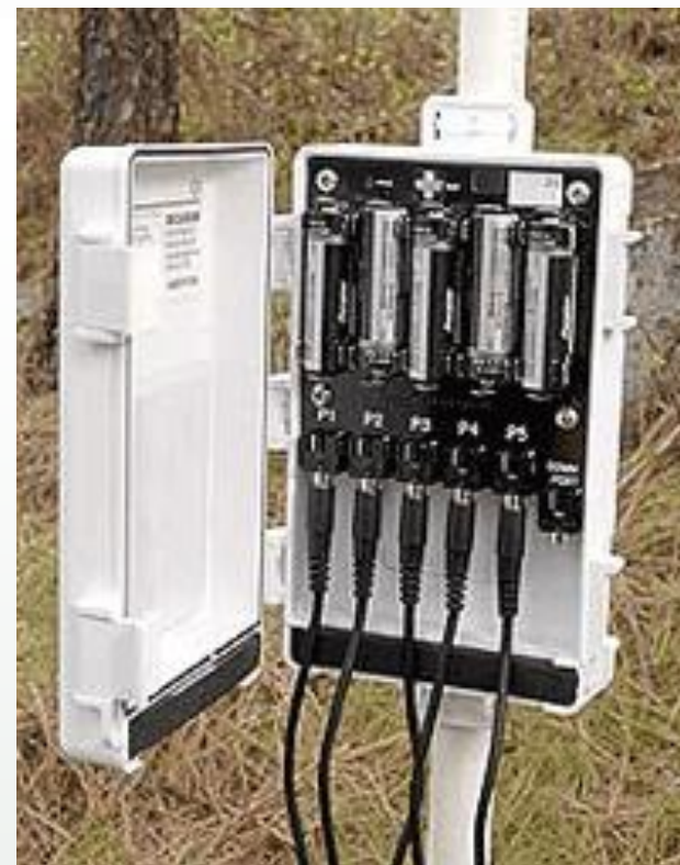
1 base station og 10 dataloggere med hver 5 jordfugtighedssensorer
